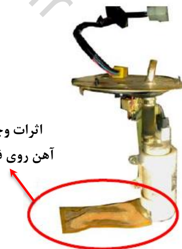
شکل شماره (۱۲) وجود زنگ آهن در داخل باک و روی فیلتر بنزین
