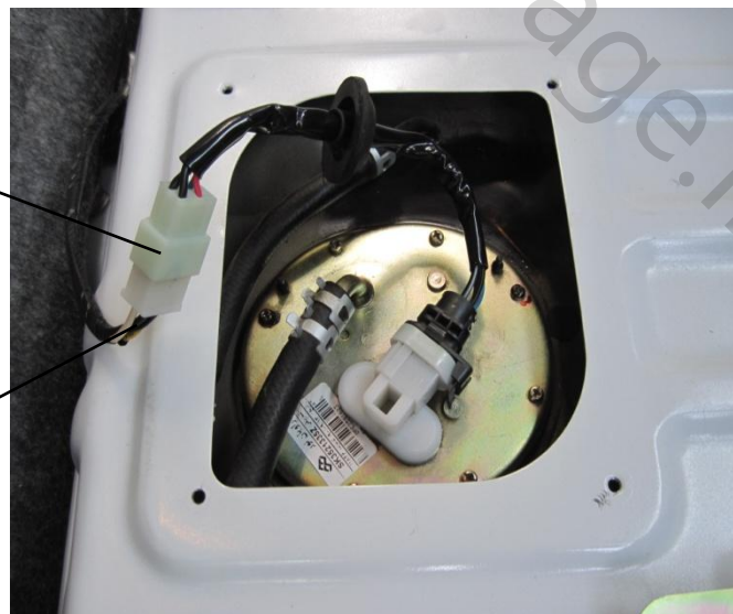
شکل شماره ( ۹ ) دسته سیم و سوکت پمپ بنزین
