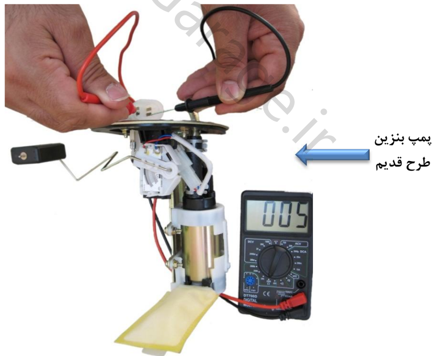
شکل شماره (۱۴) تست میزان اهم درجه داخل باک در موقعیت پر بودن سوخت
